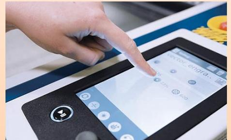
大型タッチスクリーンのパネル操作でジョブの選択や設定変更可能
