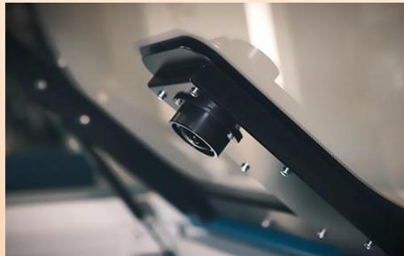
カメラを使用し加工エリア内の材料をパソコン画面表示
