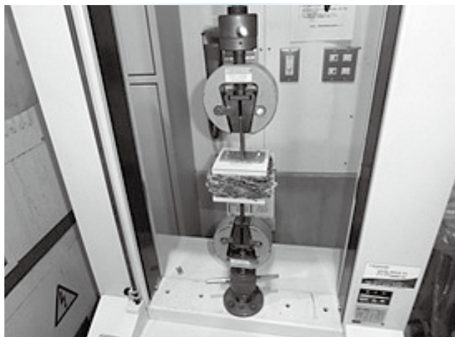
昆布ブロック引張試験の状況
